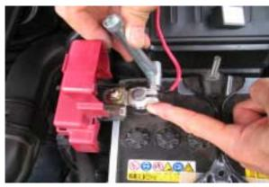
注意 工具がバッテリの取り付け金具、ネジに絶対触れないよう、布などで覆うとベター
