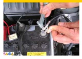
バッテリ(-)端子6mmネジの四角いビスの頭を指で抑えてナットをゆるめる。
